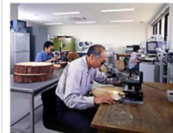
年輪幅を計測している作業風景
